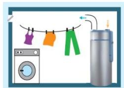
In gezeigter Darstellung kann zu- und Abluft von anderen Räumen zu und abgeführt werden oder im gleichen Raum, z.B. in einem Waschraum, der in diesem Fall entfeuchtet wird.
